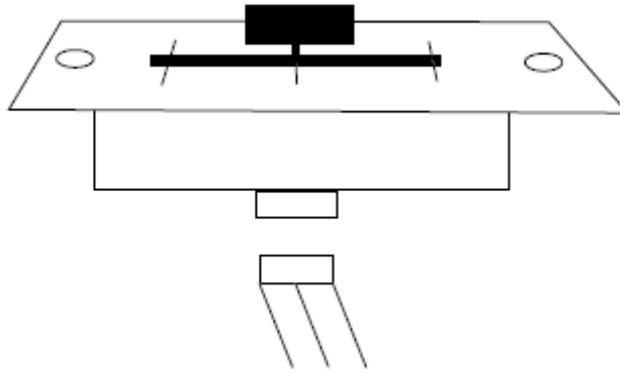
Der Crossfader ist "warm austauschbar", was bedeutet, dass er jederzeit, auch im eingeschalteten Zustand, ersetzt werden kann. Nur Feather Fader Plus von American Audio verwenden. Ein Austausch mit einem anderen Fader-Modell kann zu einer erheblichen Beschädigung Ihres Mischpults führen.
