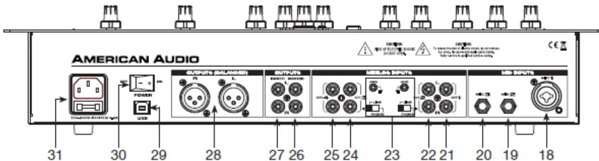
**18. MIKROFON 1** - Diese Kombibuchse nimmt einen standardmäßigen 1/4" Stecker oder einen symmetrischen 3-poligen Steckverbinder auf. Der Lautstärkepegel für dieses Mikrofon wird durch die eigene MIKROFONVERSTÄRKERREGELUNG (1) geregelt. **Hinweis: Wir empfehlen für einen optimalen Klang ein Mikrofon mit 500 bis 600 Ohm zu verwenden.**
